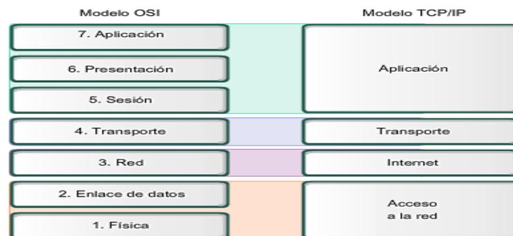
Figura1 Comparación del modelo OSI y el modelo TCP/IP [3]
