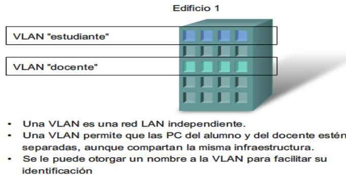
Figura 18 Ejemplo de aplicación de VLANs
