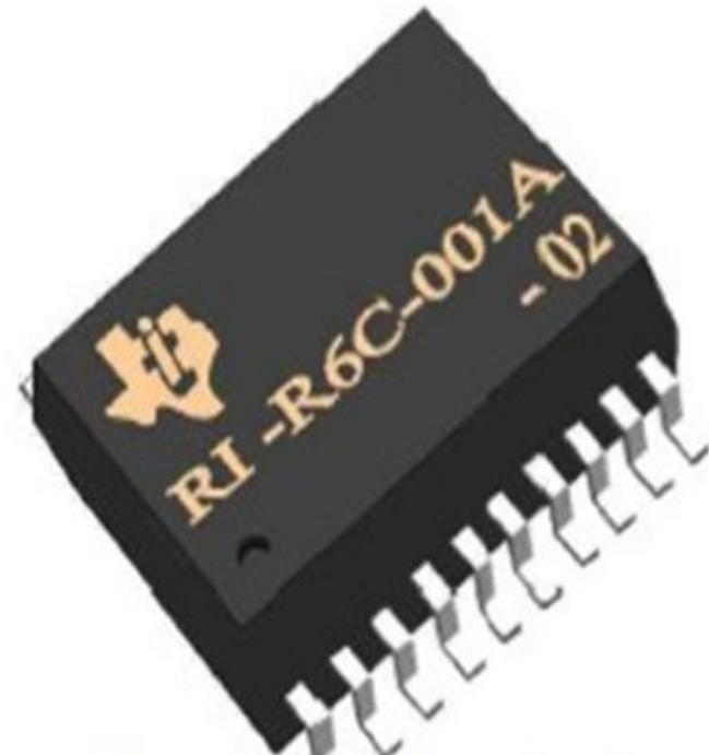
Figura b. Circuito integrado tipo plano
