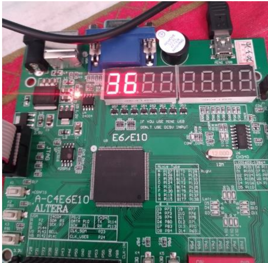
Figura 12. Contadores trabajando dentro de la tarjeta
