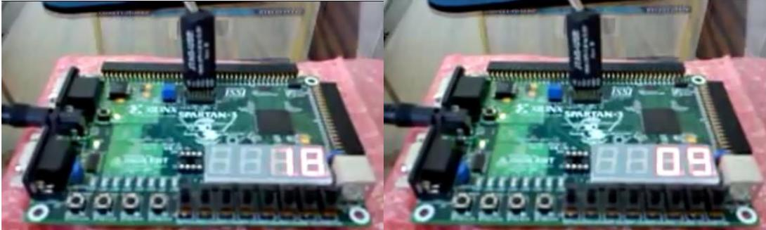
Como podemos observar en las imágenes anteriores el contador descendente (9-0) corresponde al primer display de 7 segmentos encendido y por consiguiente el segundo display de 7 segmentos encendido corresponde al contador ascendente (0-9).
